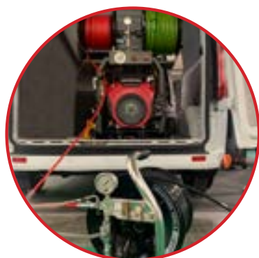
Hydroneigeur et dégorgeoirs hydropneumatiques
